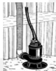
Погружной переносной без охлаждающего кожуха
